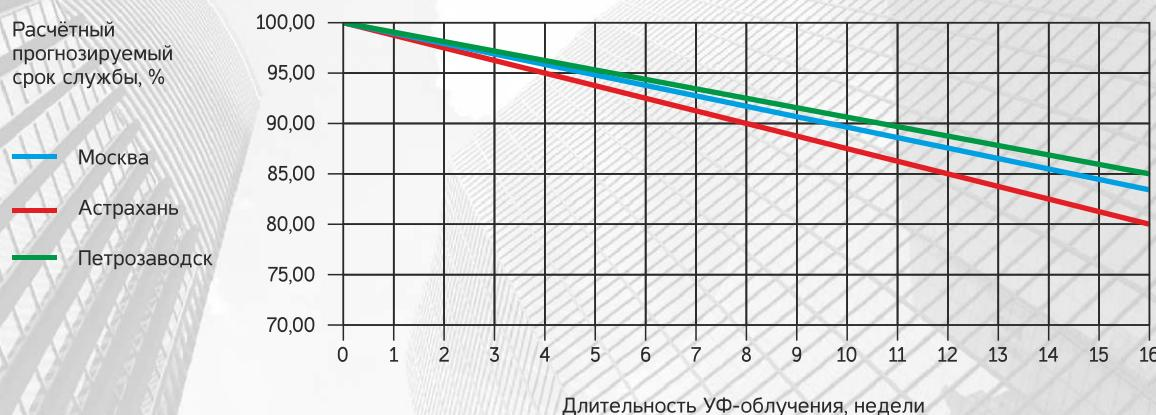
Для сохранения расчётного прогнозируемого срока службы рекомендуется в срок до 7 дней обеспечить защиту ветрозащитной мембранны от воздействия прямого, рассеянного и отражённого УФ-излучения.
