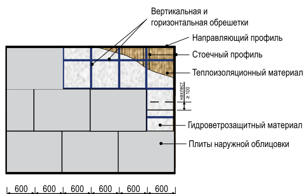
Рис. 22. Крепление наружной облицовки к каркасу
