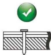
Рис. 2 Пример правильной забивки гвоздей при монтаже продукции.
