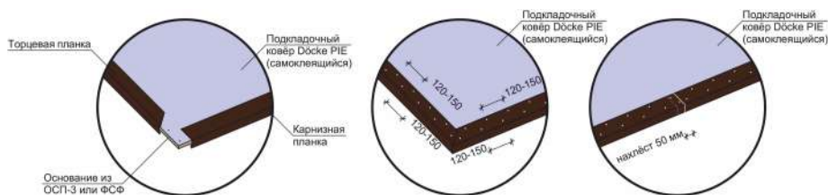
Рис. 8 Крепление металлических карнизных и торцевых планок.
