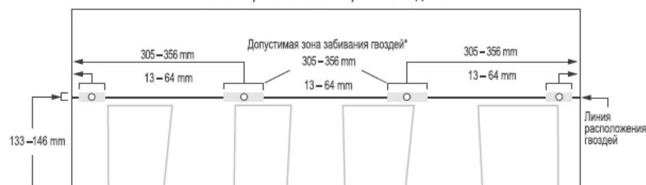
Схема крепления четырьмя гвоздями
