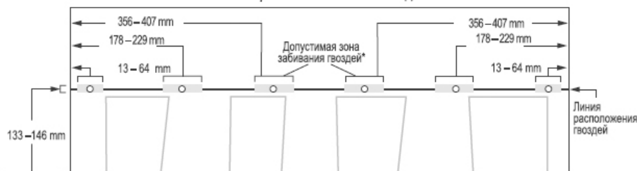
Схема крепления шестью гвоздями
